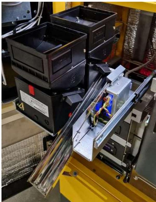
11.4.12.3. Проверка затяжки разъемов и винтовых клемм хопперов выполняется в следующей последовательности:
